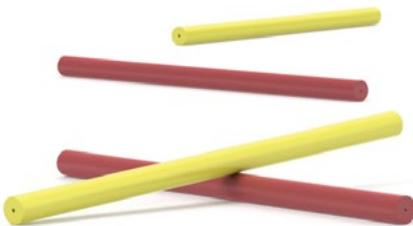
与上面的 NanoTight™ FEP 套管一样, 这些 PEEK 套管也可与 1/16" OD 10-32 螺纹接头配合使用, 使毛细管连接至标准锥形端口。这些 1.3" 长套管采用 PEEK 聚合物制成, 可在高达 125°C 的温度下使用。
