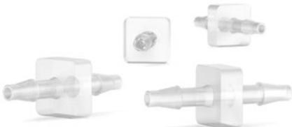
使用这些倒钩转接头连接蠕动式柔性管，适用于一般低压连接。用于制造大部分这些产品的聚丙烯均为 VI 类材料。由于聚丙烯（PP）熔点低，这些转接头不能进行高压灭菌，但是，可采用<sup>-</sup>辐射灭菌。此外，还提供 ETFE 的倒钩-母鲁尔锁连接器，其具有优异的耐溶剂性和更高的温度等级（80°C）。
