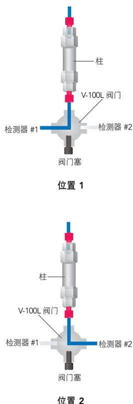
检测器切换应用可能要求能够灵活地使色谱柱流出物同时流向两个检测器, 同时保持着隔离各检测器的能力。使用我们的三通流向切换阀 (“T”), 使用内带的阀门塞堵塞第四个端口。
