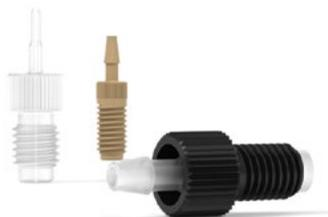
此类转接头可轻松地将柔性管连接至任何标准1/4-28平底或10-32锥形接收端口。将转接头简单地螺旋扭入接收端口，并将管子套在倒钩杆上，创建可靠的低压连接。
