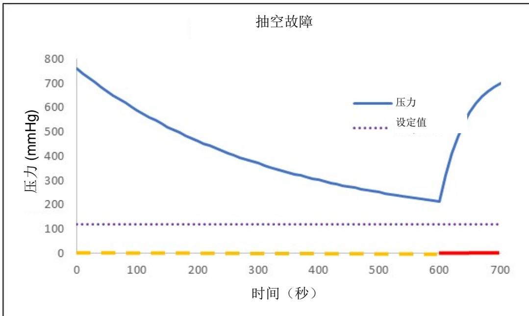
如果压力达到设定值，然后将出现真空损失，LED将在大于等于设定值以上30 mm时闪烁琥珀灯，高于设定值低于设定值以上30 mm时闪烁绿灯，达到设定值时呈实心绿色。如果存在暂时真空损失期间6分钟内无法达到设定值，泵将停止运行，LED将变为实心红色（图中未显示）。
