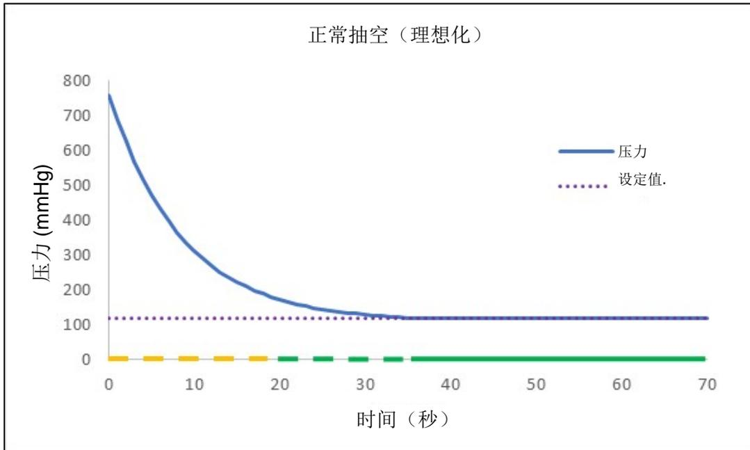
如果10分钟后压力无法达到设定值，泵将停止运行，LED将变为实心红色。
