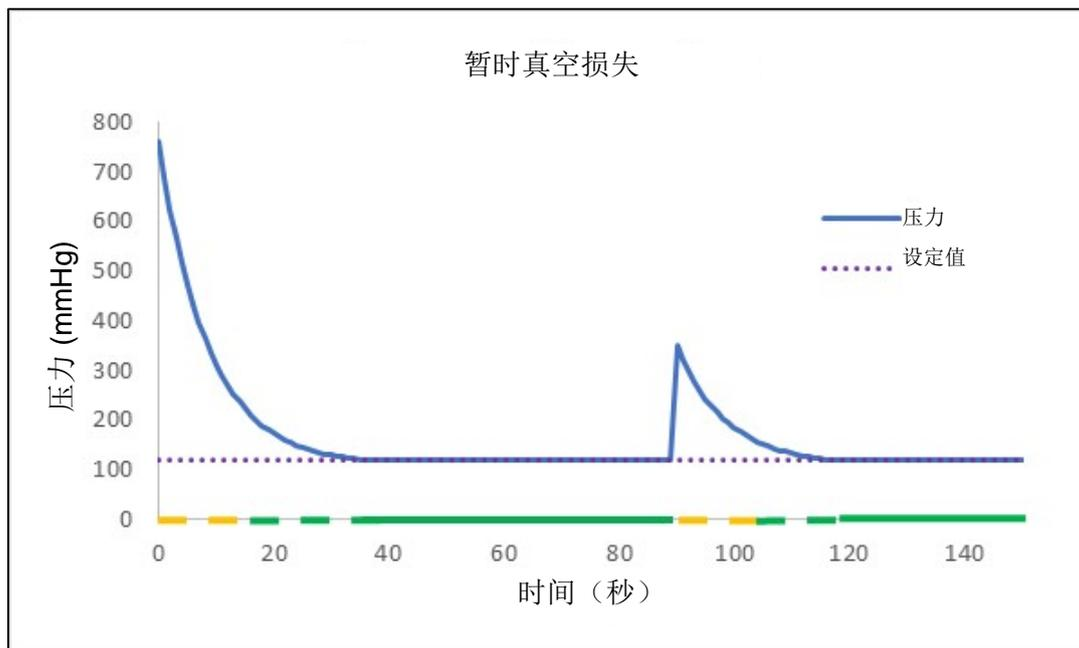
如何压力在任何时候高于设定值以上30毫米，且真空值没有显著下降时，泵将在几秒钟内停止运行，LED将变为实心红色。这表明真空存在严重丧失，无法抽空。这可能是由于真空管路开路造成的。如果在启动时发生这种情况，泵将运行几秒钟，然后停止运行。
