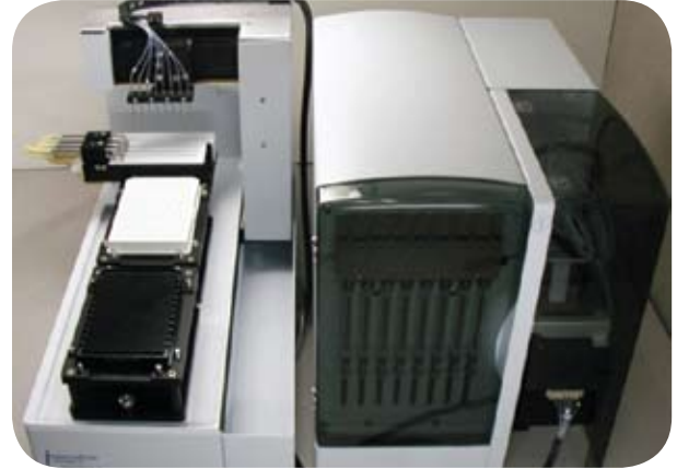
Nanodrop II 固定模块和流控模块
